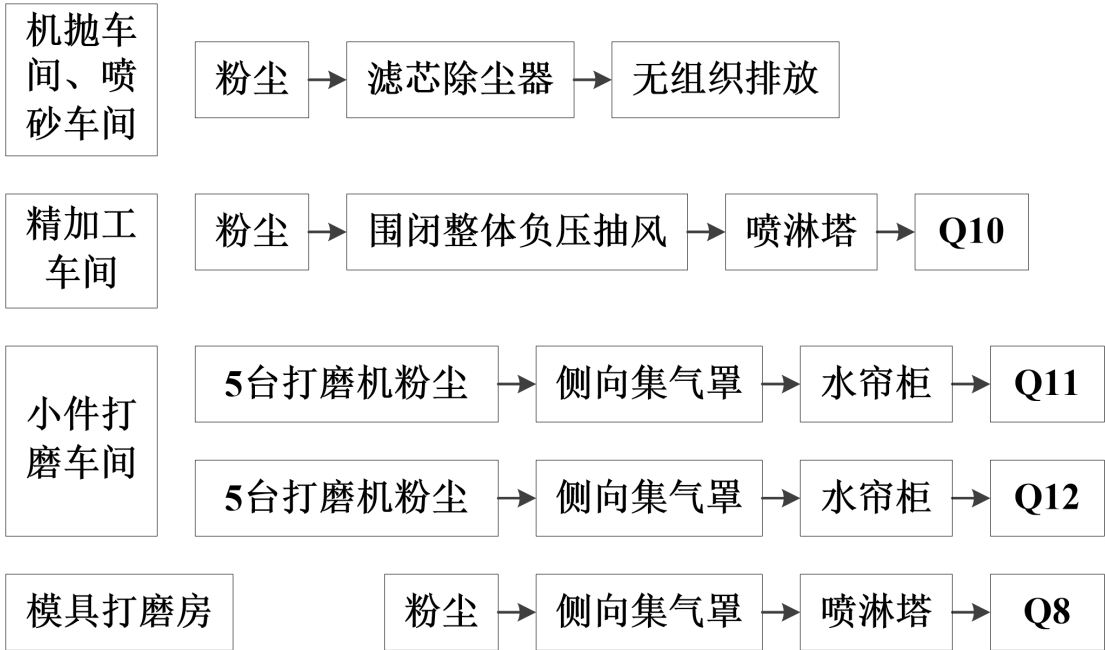
图 7.2-7 机加工粉尘处理工艺流程图
