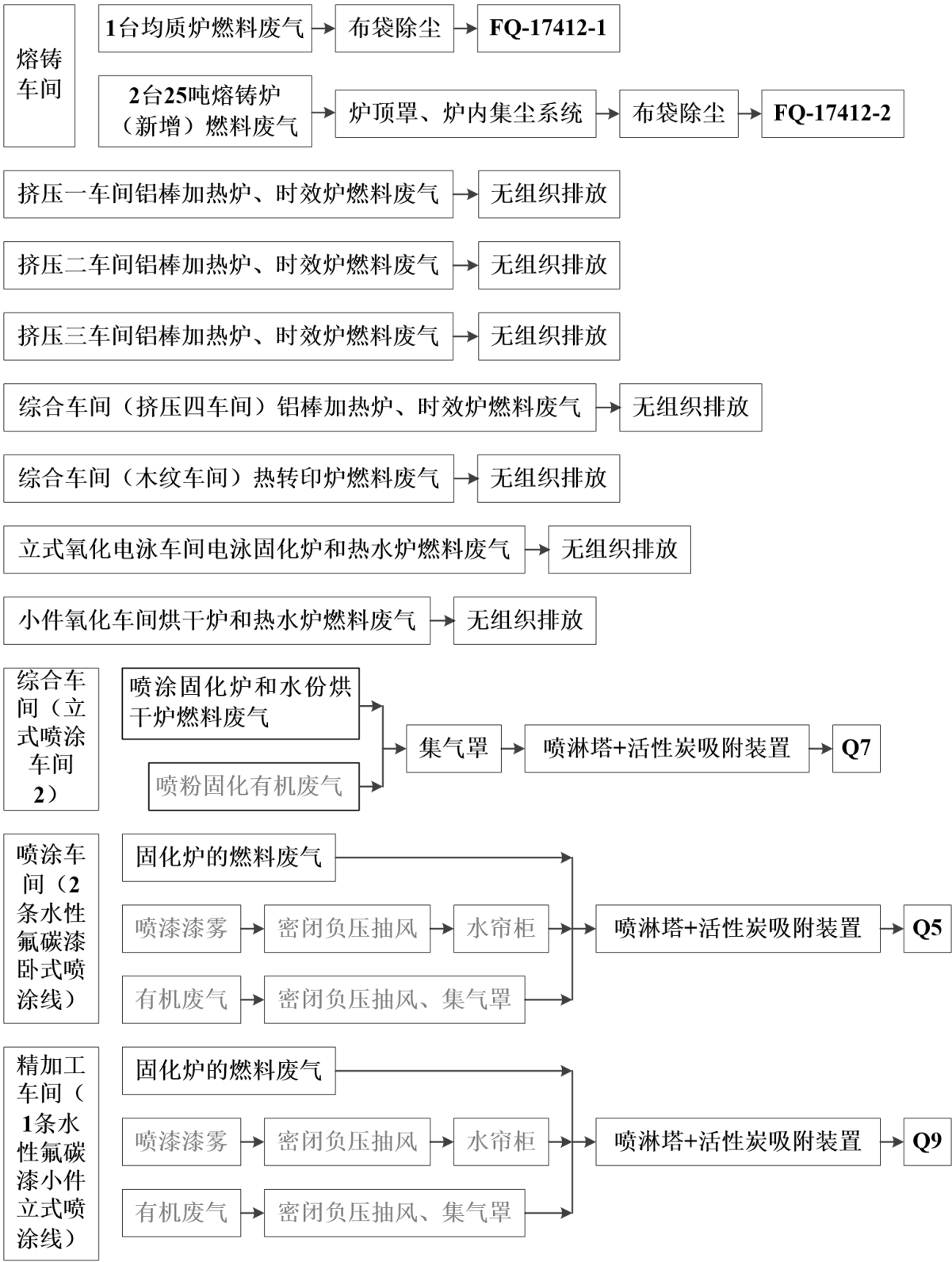
图 7.2-2 天然气燃料废气处理工艺流程图
